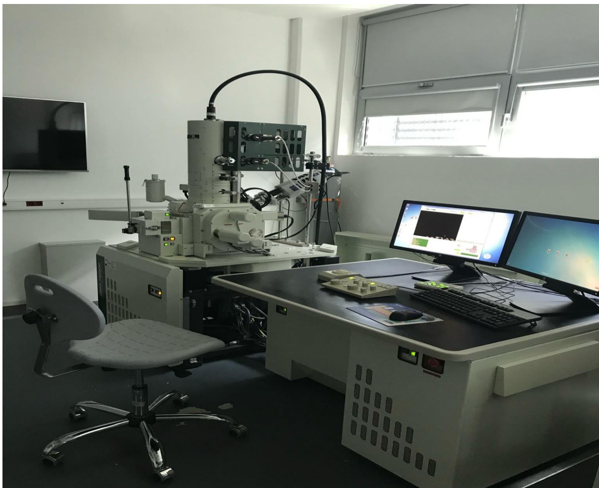
Slika 13. Pretražni mikroskop Quanta 250, autorski rad
