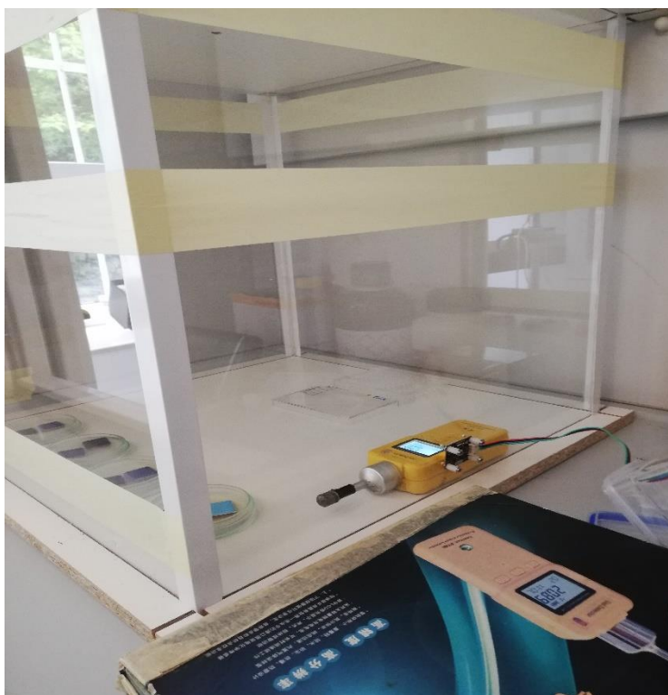
Slika 8. Kutija za provođenje in vitro tretmana plinovitim ozonom, autorski rad
