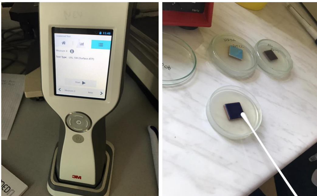
Slika 12. Luminometar 3M Clean-Trace™ (lijevo) i keramička pločica u agaru (desno), autorski rad
