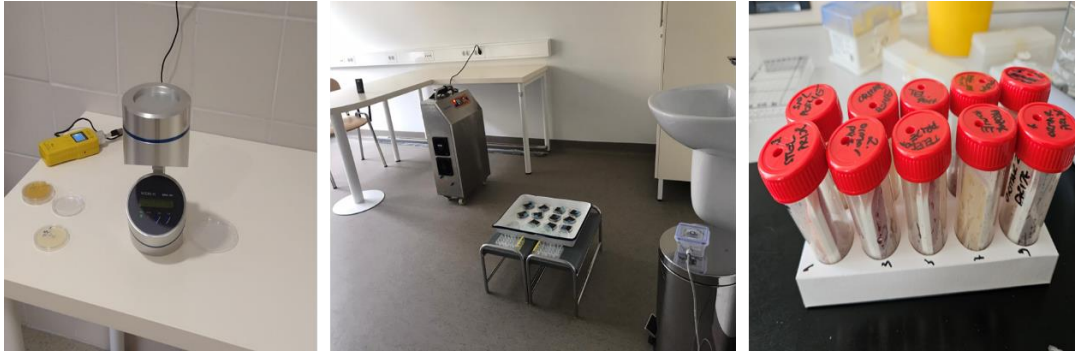
Slika 14. Uređaj za uzorkovanje zraka MAS Merck (lijevo), soba za postoperativni tretman sa biofilmom model organizama (sredina) i pločice za određivanje mikrobiološke čistoće prostora (desno), autorski rad
