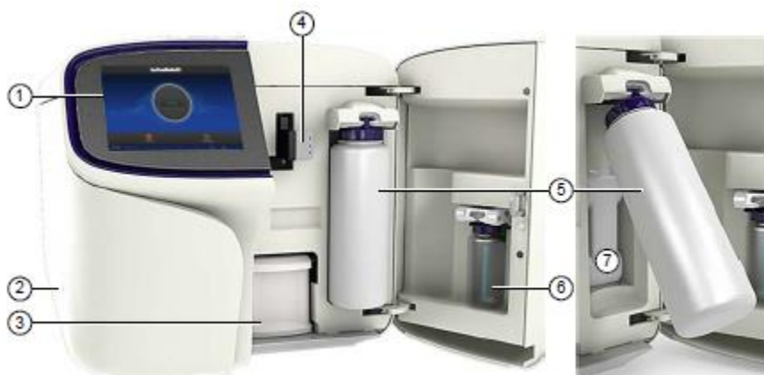
Slika 3.5. Ion S5 Ion GeneStudio S5 System uređaj 1 –Touchscreen; 2- Gumb za uključivanje; 3- Ion S5 Reagents spremnik; 4- utor za čip; 5- Boca za Ion S5 Solution wash solution; 6- Boca za Ion S5 Cleaning solution; 7- spremnik za otpad
