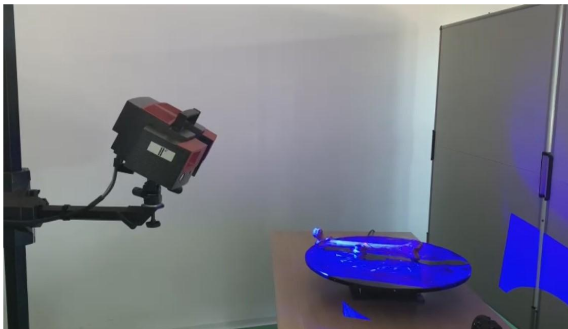
Slika 24. Trodimenzionalno (3D) skeniranje femura pomoću ATOS II i ATOS III sustava s trostrukom kamerom. Slika prikazuje položaj femura na podlozi koja se tijekom skeniranja rotira.
