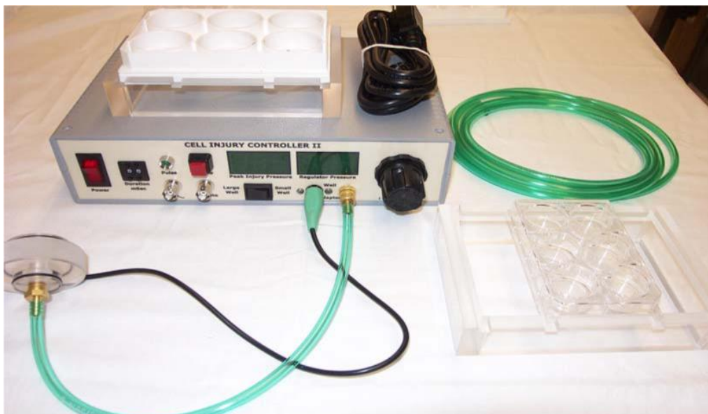
Slika 6. Cell injury controller II, uređaj za provođenje in vitro ozljede rastezanjem.
